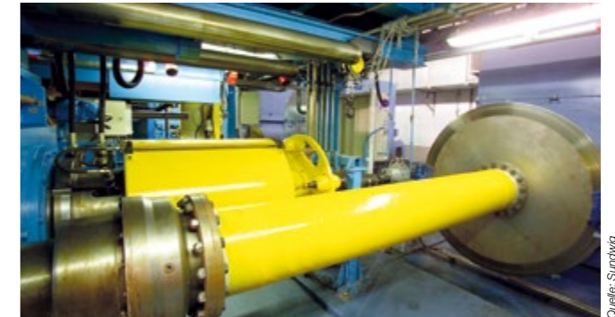
Bogenzahn-Kupplung® SBLKT 225, Haspelantrieb im Kaltwalzwerk
