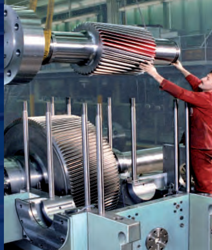
G-100-Getriebe zur Stromerzeugung auf der Schiene, das 20 MW überträgt bei einer Drehzahl von 2976/1000 Upm.
