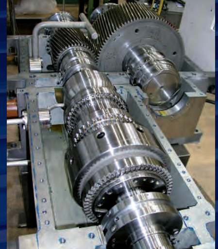
Montage eines Spezialgetriebes Typ G-36s, einschließlich einer HS-26 Synchron-Schaltkupplung, speziell konstruiert für den Antrieb von Gasexpandern.
